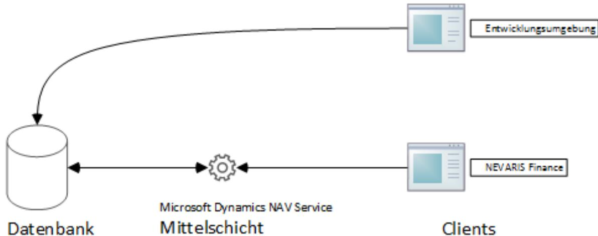
NEVARIS Finance basiert auf der Plattform Microsoft Dynamics NAV in der Version 2018 (kurz NAV 2018). Die Architektur von NAV 2018 ist eine 3-Schichten Architektur, bestehend aus Datenbank, Mittelschicht und Client. Im Folgenden sind die einzelnen Schichten kurz erläutert.
